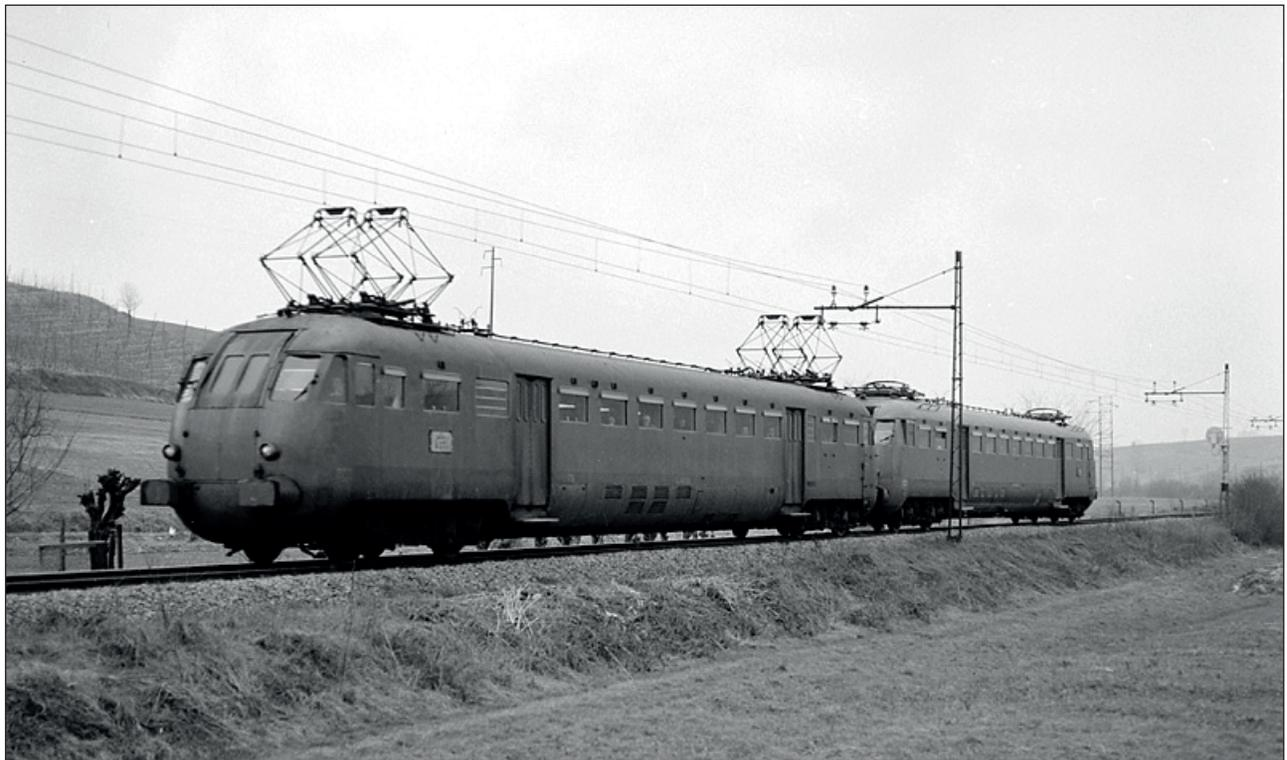
Une véritable antiquité. En Italie, les premières électrifications furent basées sur les technologies disponibles à l'époque, à savoir la traction triphasée. Rapidement devenu obsolète, ce système fut remplacé par le 3 kV continu. Une des caténaires fut déposée et l'autre simplement décalée, et le tour était joué !
